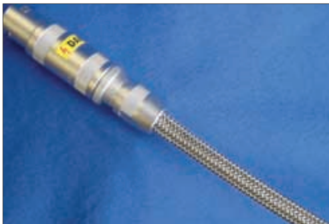
Helagaine EMC-punottu suojasukka on valmistettu nikkelpinnoitetuista kupari- ja polyesteri langoista.
