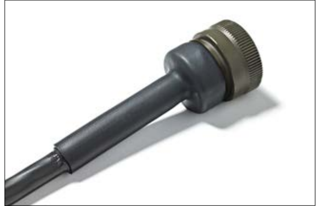
EPS-300 ja EPS-400- liimallisilla kutistemuoviletkuilla on laaja kutistussuhde ja suojaavat hyvin kosteudelta.
