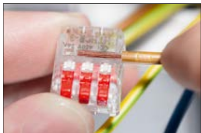
10 mm kuorintaetäisyys voidaan tarkistaa liittimestä.
