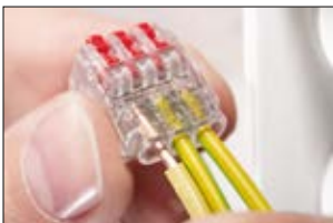
Lankamaiset johtimet (ML) voidaan työntää HCR-sarjan rasialiittimeen lukitusta avaamatta.
