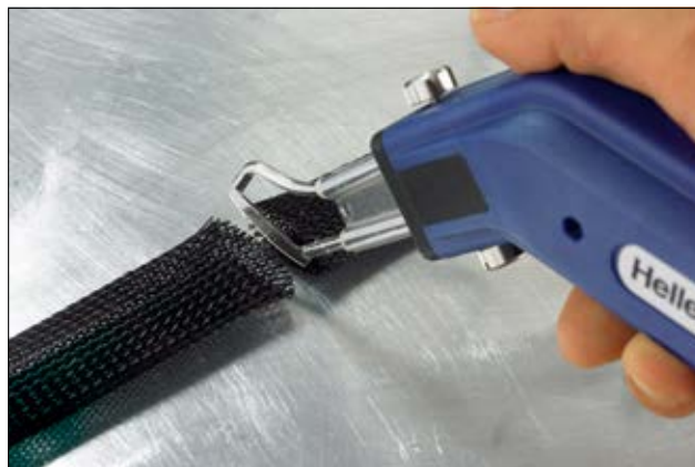
HSG0 - työkalun käyttö estää punotun suojasukan säikeiden purkaantumisen.
