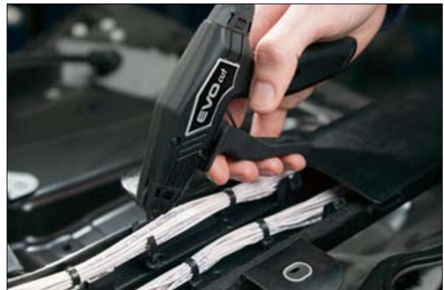
Katkaisu onnistuu yhdellä kädellä.
