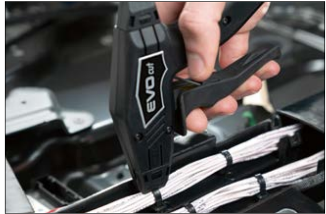
Johdinside voidaan katkaista mistä sidenauhan kohdasta tahansa.
